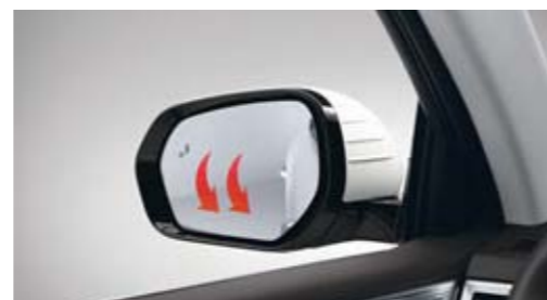
Înclinarea automată a oglinzii retrovizoare exterioare la mersul înapoi
