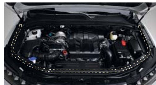
Izolație de jur împrejur a compartimentului motorului
