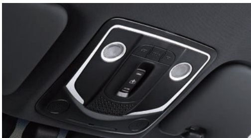
Consolă plafon cu lumină de citire și comutatoare control trapă
