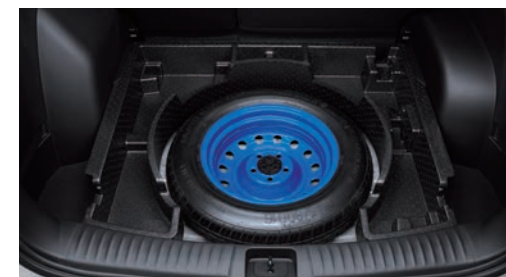
Roată de rezervă temporară
