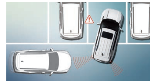
RCTA (Rear Cross Traffic Collision Assist/Asistare coliziune trafic în spate) | RCTW (Rear Cross Traffic Warning/Avertizare trafic în spate)
