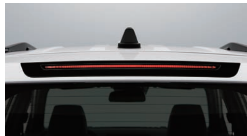
Lumină stop LED montată la înălțime
